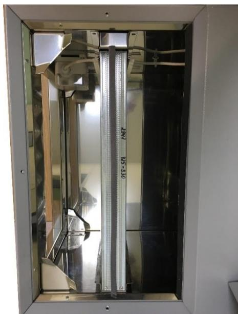
**Корпус установок производится из нержавеющей стали, внутренние элементы установок - из оцинкованной стали, пластины на теплообменника покрыты эпоксидным составом, что повышает устойчивость к коррозии и воздействию агрессивной среды.**
